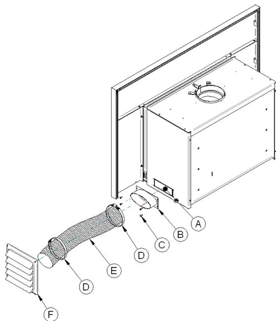
Par la suite, installez l'adaptateur d'entrée d'air (B) à l'aide de 4 vis (C). Fixez le tuyau flexible (E) (pièce AC02090 non fournie) sur l'adaptateur (B) à l'aide d'un des collets ajustables (D). Fixez l'autre extrémité au capuchon de prise d'air (F) à l'aide du deuxième collet ajustable (D). Le capuchon de prise d'air (F) doit être installé à l'extérieur de votre habitation.
