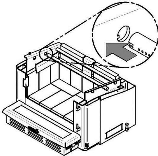
2. Alignez le chemin du tube et la dent dans le trou correspondant de la canalisation gauche.
