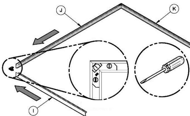
Insérez les équerres (G) et (H) superposé avec les vis (F) dans les rainures de chaque moulure décorative (I), (J) et (K). Alignez les coins du côté à angle de chaque moulure, puis serrez les vis (F) pour sécuriser l'ensemble de moulures.
