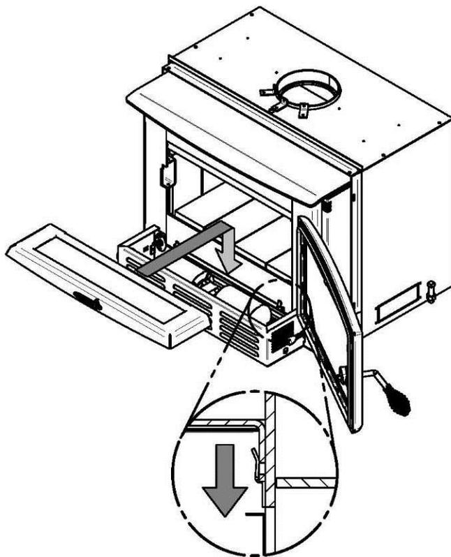
Pour assembler la tablette, ouvrez la porte au maximum afin de faciliter l'installation. Alignez la tablette avec le boîtier du ventilateur et appuyez-la contre la boîte à feu. Ensuite poussez vers le bas afin d'insérer le pli arrière de la tablette dans les attaches fixées à l'encastable sous la porte de chargement.
