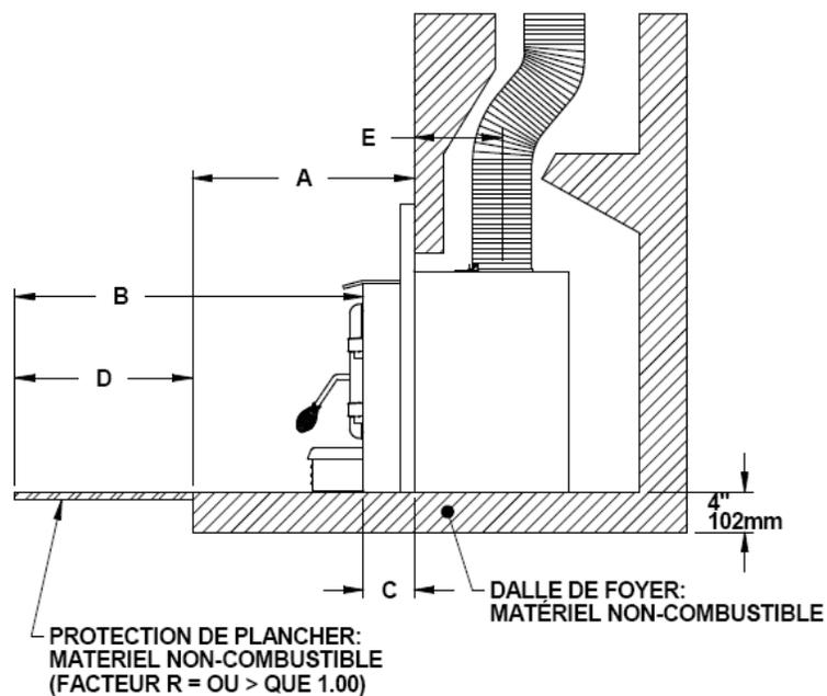
L'utilisation de la valeur R est pratique lorsque plus d'un matériau est utilisé dans la protection de plancher installé devant l'extension de l'âtre pour couvrir la surface combustible. En effet, les valeurs R sont additives, tandis que les valeurs K ne le sont pas.
