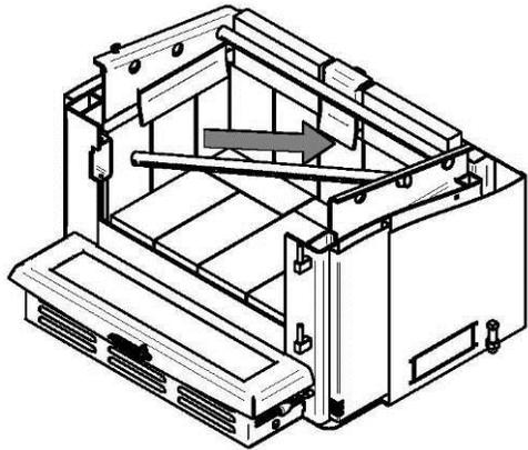
1. En commençant vers l'arrière, inclinez et insérez le tube d'air secondaire arrière dans le trou du fond de la canalisation droite.
