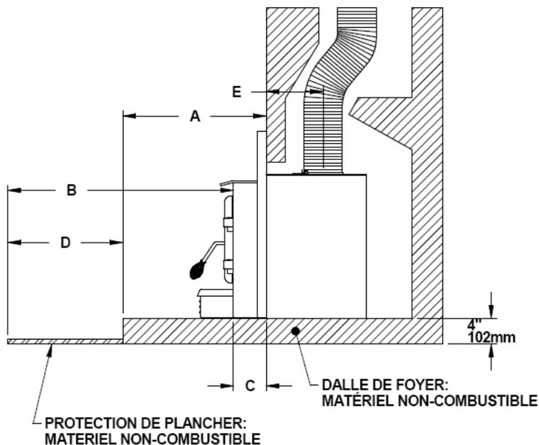
Si une protection de plancher en matériau non combustible devait être ajoutée au niveau de l'âtre de maçonnerie, un facteur R égal ou supérieur à 1,00 est nécessaire.
