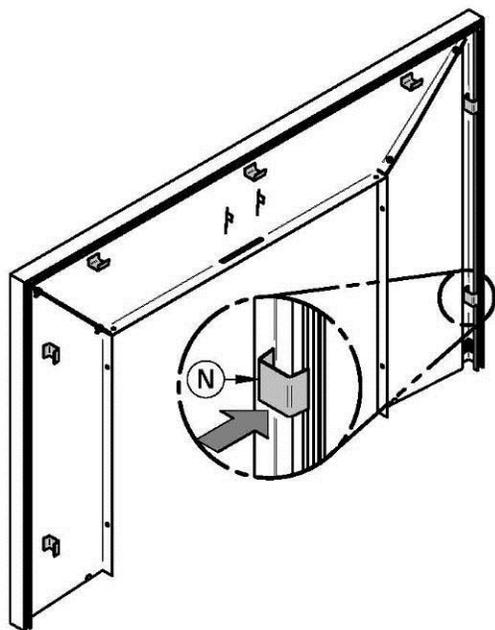
Fixez la moulure à la façade en insérant les huit attaches (N) entre le bord intérieur de la moulure et l'avant de la façade. Comme dans l'image sur la gauche.
