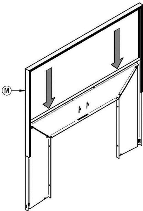
Alignez l'ensemble de moulures assemblées (M) sur le bord gauche et droit de la façade et faites-le glisser lentement vers le bas le long de la façade.
