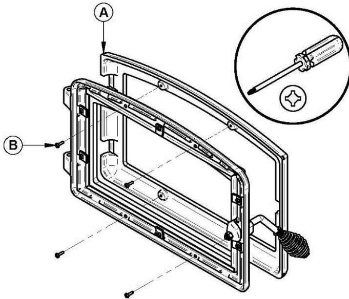
Positionnez le revêtement (A) sur la porte et fixez-le en place par l'intérieur de la porte en utilisant les 4 vis (B) fournies.
