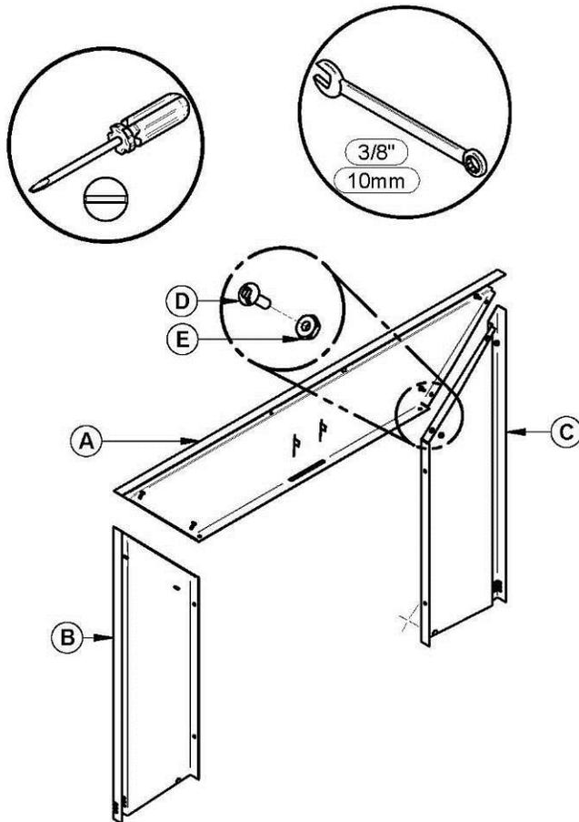
Alignez les trous du panneau supérieur (A) avec les trous des panneaux latéraux (B) et (C). Fixez-les en utilisant quatre (4) boulons (D) et écrous (E) fournis.
