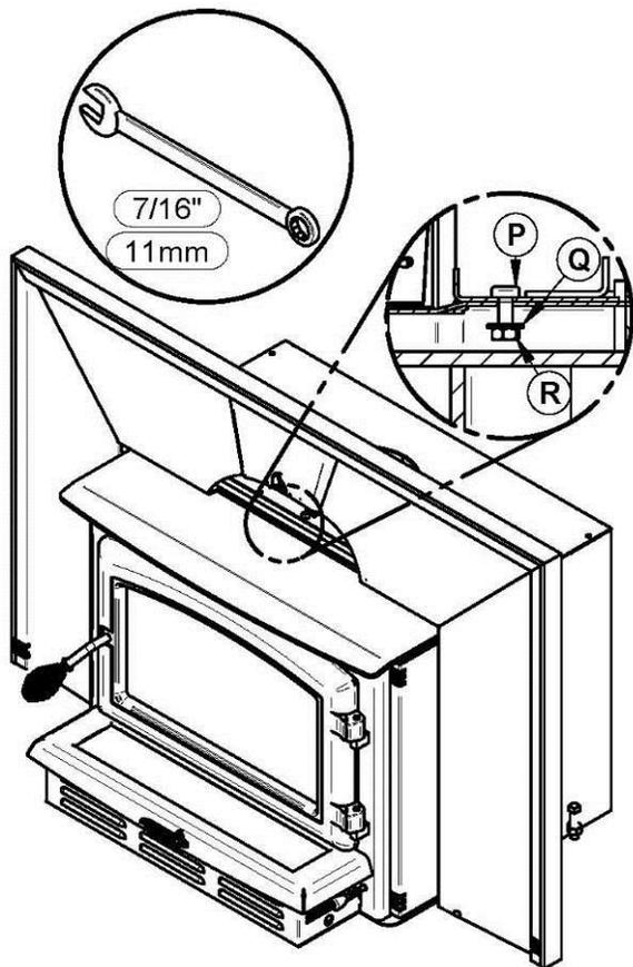
Alignez l'encoche dans l'extension de la façade avec le boulon soudé (P) au centre de l'enveloppe de convection. Ajustez à la profondeur désirée et sécurisez en place à l'aide de la rondelle (Q) et de l'écrou (R) à l'aide d'une clé 7/16" (11 mm).
