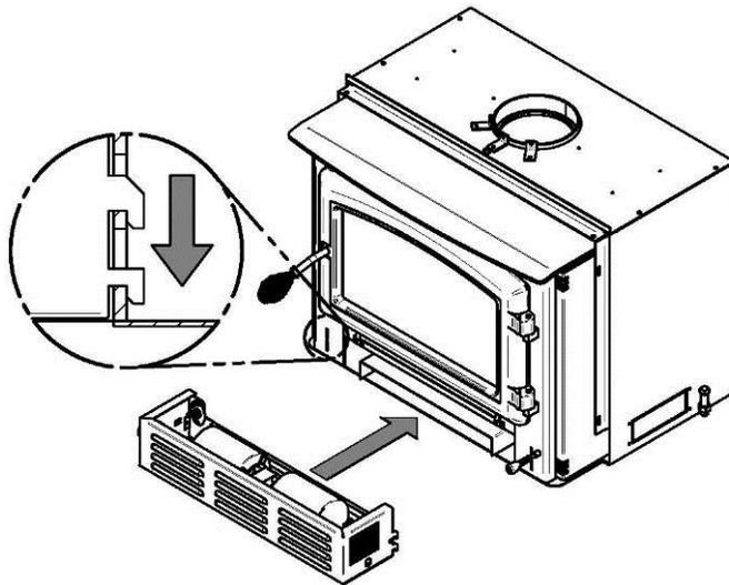
Attachez l'assemblage du ventilateur à l'encastable en insérant les crochets du boîtier dans les encoches localisées à gauche et à droite de l'ouverture sous la porte de chargement.
