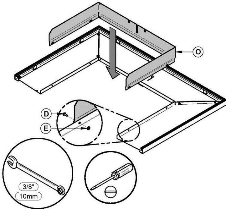
Ensuite, alignez les trous dans l'extension de la façade (O) avec les trous dans chaque panneau latéral de la façade et fixez-les en utilisant quatre (4) boulons (D) et écrous (E) fournis.
