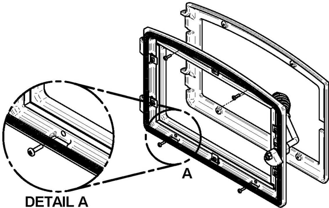
Positionnez le revêtement sur la porte et fixez-le en place par derrière en utilisant les 4 vis.
