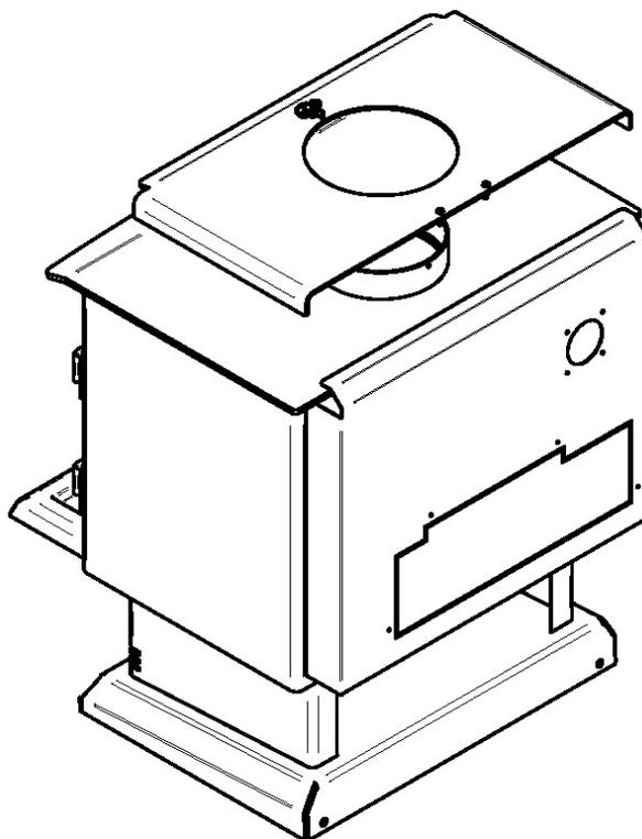
**Note :** Bien que ce ne soit pas nécessaire, vous pouvez fixer votre échangeur de chaleur supérieur sur le déflecteur de chaleur arrière en utilisant les trous prévus à cet effet à l'aide de 2 vis auto-perforantes fournies avec la grille «air mate». Vous pouvez aussi simplement le déposer sur le dessus du poêle.
