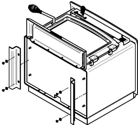
Dévissez les 4 écrous pour enlever les 2 supports d'acier. Disposez des 2 supports d'acier. Ils ne sont plus nécessaires.
