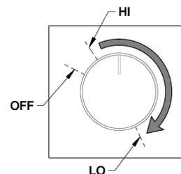
Lorsqu'on utilise le ventilateur optionnel, il faut laisser le poêle atteindre sa température de marche (environ une heure) avant d'actionner le ventilateur. L'augmentation du courant d'air produit par le ventilateur refroidit la chambre à combustion et peut nuire au rendement d'un début de combustion si le ventilateur démarre trop tôt. Votre ventilateur est muni d'un thermodisque qui permet au ventilateur de fonctionner seulement quand le poêle est assez chaud.
