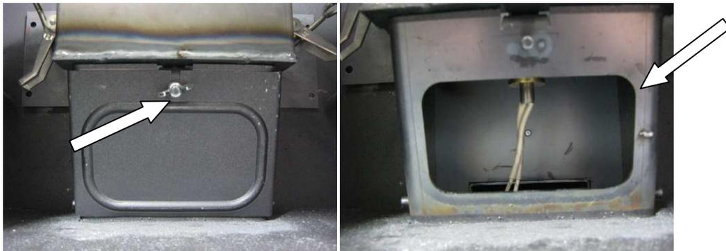
4. Vérifiez que le joint d'étanchéité de la trappe d'accès est en bonne condition, sinon remplacez-le.
