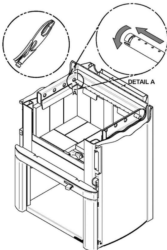
2. Alignez le chemin du tube et la dent dans le trou de la canalisation. Tenez le tube à l'aide d'une pince de serrage et suivez le mouvement décrit dans la figure ci-contre (**DÉTAIL A**) pour le sécuriser en place. S'assurer que la dent touche le fond du chemin du tube.
