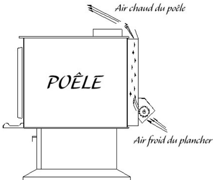
Il est également possible d'installer un thermodisque à branchement éclair, inclus avec votre appareil, qui permet au ventilateur de fonctionner seulement quand le poêle est assez chaud.
