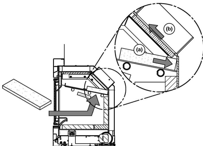
7. Installez le premier panneau de vermiculite (a) sur ses supports. Assurez-vous que le panneau isolant (b) situé au pourtour de la buse à l'intérieur de la chambre à combustion soit bien poussé vers le haut afin que le coupe-feu (a) s'appuie bien au dos de la chambre à combustion.
