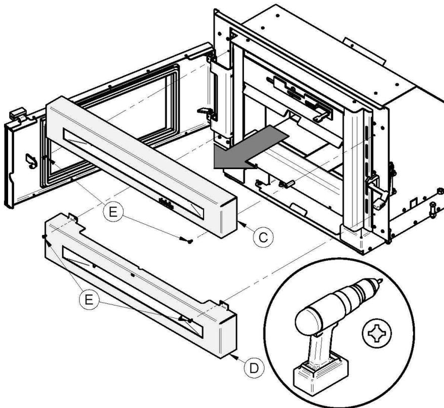
2. Ouvrez la porte de l'appareil. À l'aide d'une visseuse et d'un embout Philips, retirez la façade supérieure (C) et la façade inférieure (D) retenues par les vis (E).
