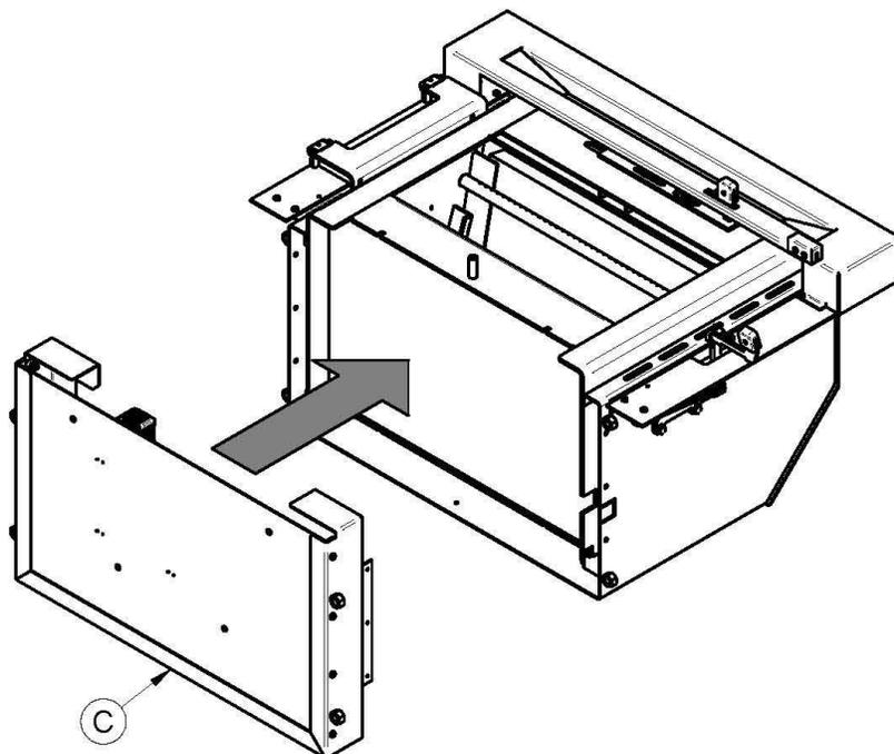
À l'aide d'une visseuse et d'un embout hexagonal 5/16" (8 mm), fixez la base à l'aide de 3 vis (D) de chaque côté de l'appareil.
