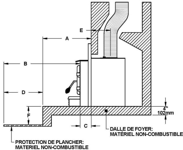
Si une protection de plancher en matériau non combustible devait être ajoutée au niveau de l'âtre de maçonnerie, un facteur R égal ou supérieur à 2 est nécessaire.
