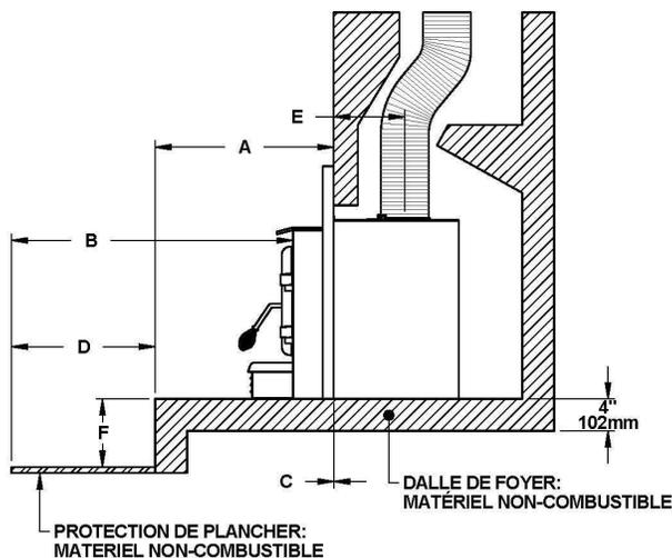
**Données pour calcul de la protection de plancher au niveau de l'âtre de maçonnerie avec facteur R de 2 ou plus**
