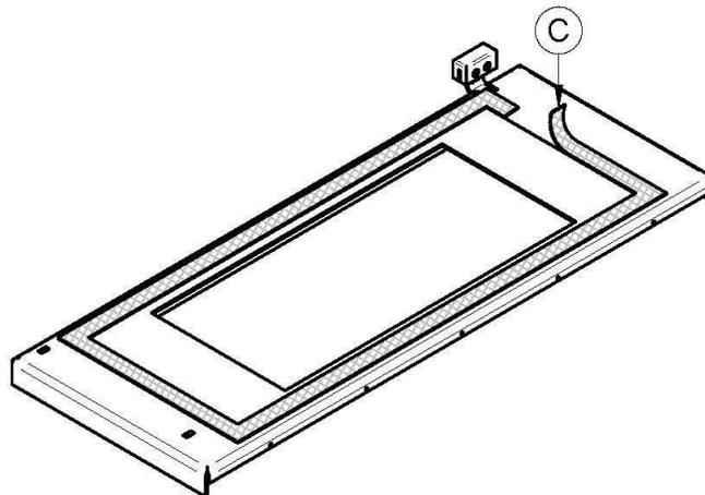
Remplacez la vitre, en prenant soin de bien centrer la vitre dans la porte. Ne pas trop serrer les vis. Remarquez que les deux principales causes de bris de vitre sont un positionnement inégal dans la porte et des vis de rétention trop serrées.
