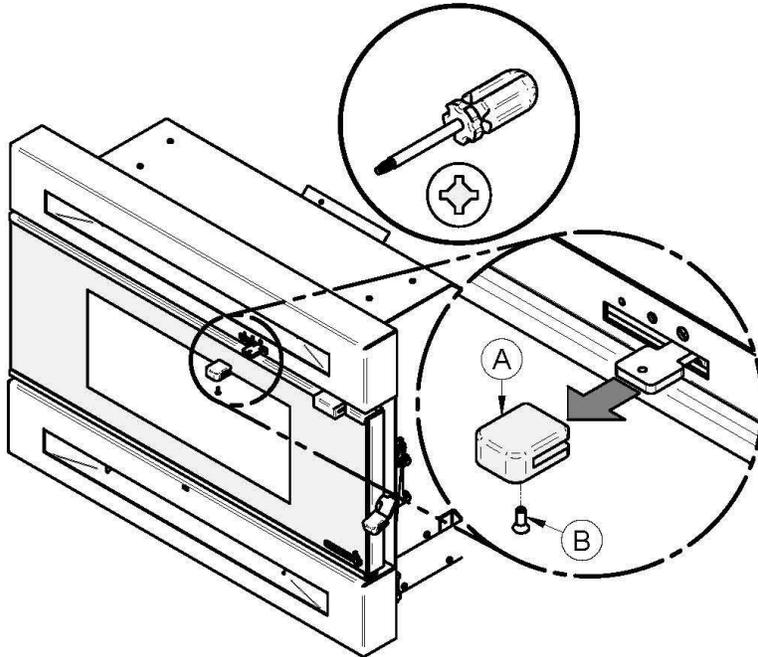
1. À l'aide d'un tournevis Philips, retirez la poignée de bois (A) du contrôle d'air retenu par la vis (B).
