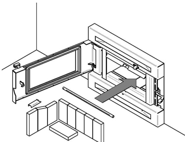
9. Remettez le tube d'air secondaire en place, suivi des briques et du support de brique retirés à l'Étape 1.
