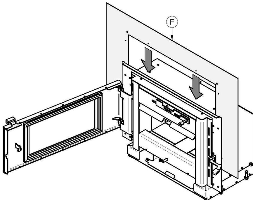
3. Glissez le panneau de finition arrière (F) derrière le cadre de l'appareil.
