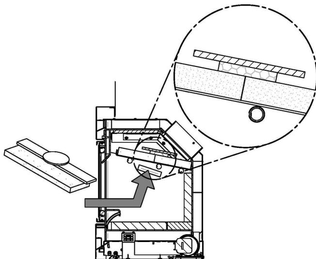
8. Insérez le deuxième coupe-feu en prenant soin d'y ajouter la laine isolante ainsi que le poids de laine. Installer le coupe-feu sur les supports dans la chambre à combustion. Placez la laine sur le joint des 2 panneaux coupe-feu.
