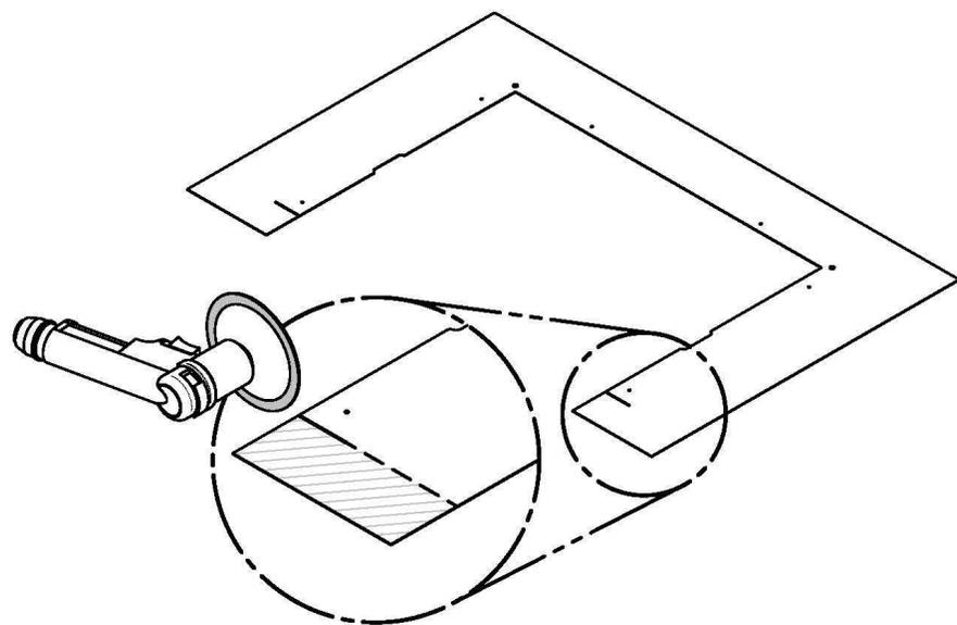
Pour une installation avec l'option de façade inférieure sans ventilateur (AC01352). Avant d'entreprendre l'installation, découpez les parties inférieures du panneau de finition arrière à partir des encoches prévues à cet effet avec une scie à métal rotative.
