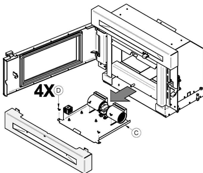
2. Dévissez les 4 écrous papillon (D) retenant en place la plaque support (C) du ventilateur. Sortir l'ensemble.
