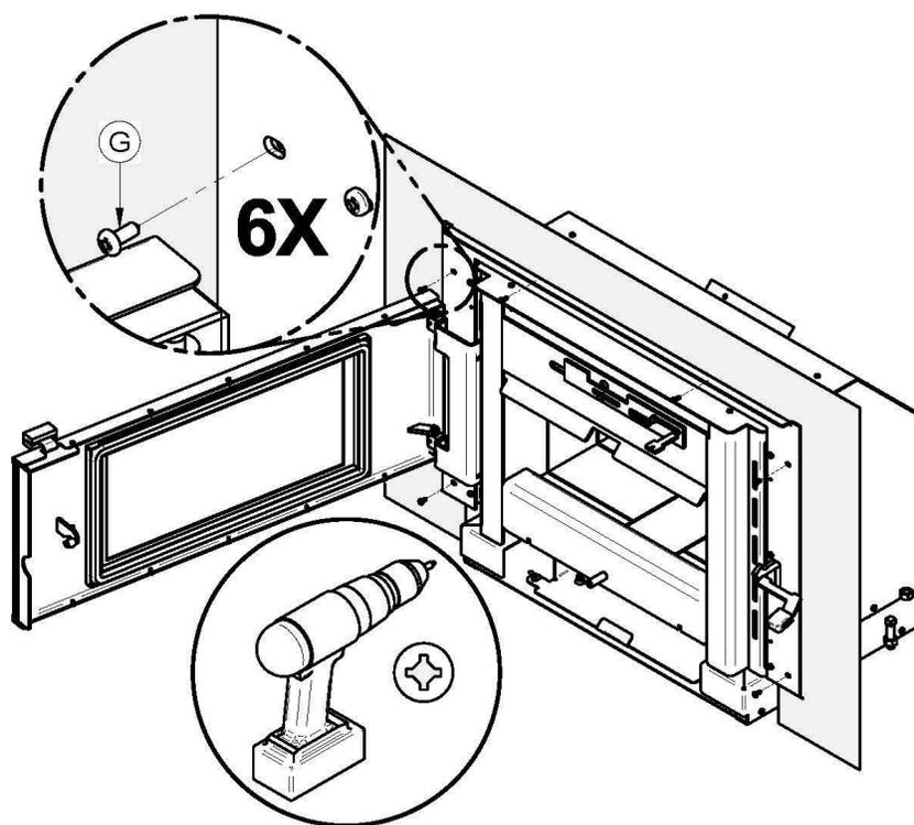
4. À l'aide d'une visseuse et d'un embout Philips, fixez le panneau de finition arrière au cadre avec 6 vis (G).
