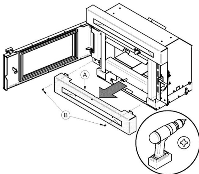
1. À l'aide d'une visseuse et d'un embout Philips, retirez la façade inférieure (A) retenue par 2 vis (B).
