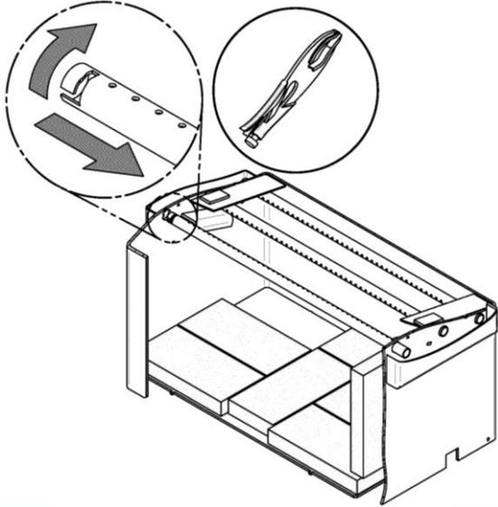
2. Pour retirer le tube d'air secondaire, tenez-le à l'aide d'une pince de serrage et suivez le mouvement décrit dans la figure ci-contre.
