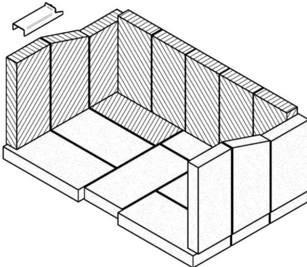
1. Retirez de la chambre à combustion les briques hachurées (9) et le support de brique gauche tel qu'indiqué sur le schéma.
