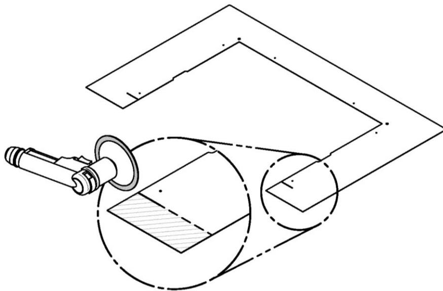
Pour une installation avec l'option de façade inférieure sans ventilateur (AC01352). Avant d'entreprendre l'installation, découpez les parties inférieures du panneau de finition arrière à partir des encoches prévues à cet effet avec une scie à métal rotative.
