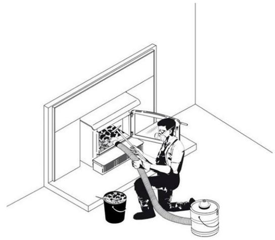
L'inspection et le nettoyage de la cheminée peuvent être facilités en retirant le coupe-feu. Voir [«Annexe 9: Installation des tubes d'air et du coupe-feu»](#) pour plus de détails.
