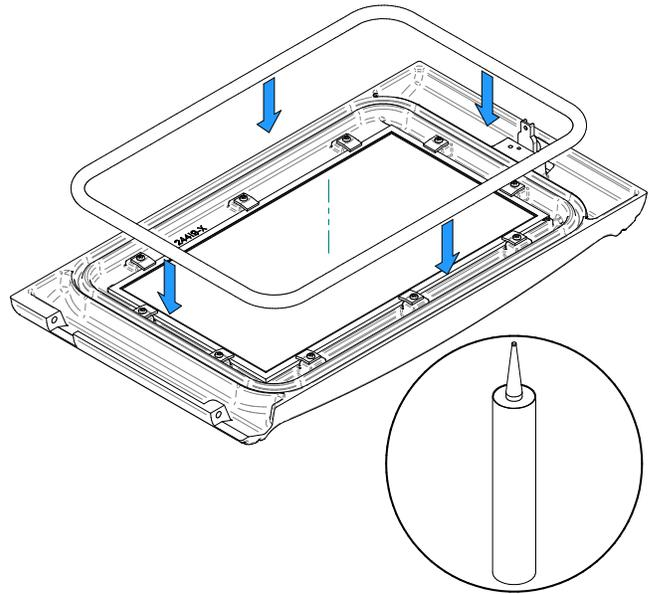
Figure 35: Joint d'étanchéité de la porte de la chambre à combustion
