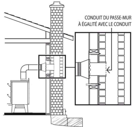
Figure 48: Installation dans un âtre de maçonnerie
