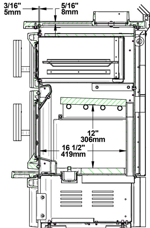
Figure 6: Vue de côté - chambre à combustion
