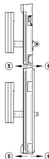
Figure 34: Ajustement en profondeur des pentures excentriques
