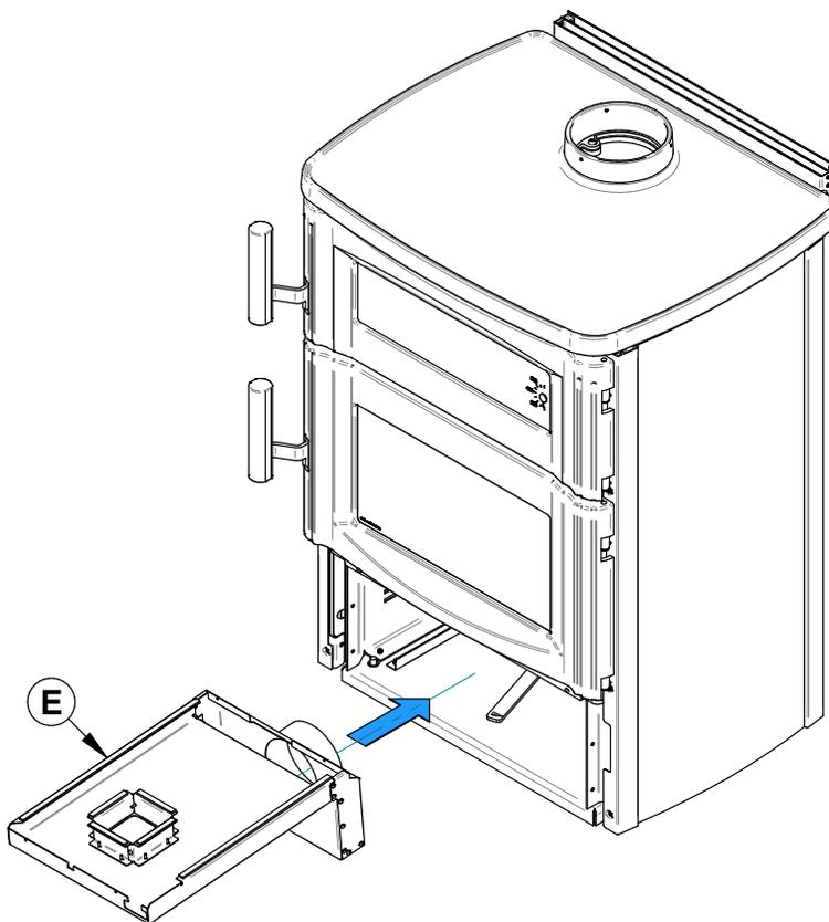
Lever le boîtier de prise d'air pour l'appuyer sous le fond de la chambre à combustion. Fixer-le à la base à l'aide de deux vis **(F)** à l'avant et 2 vis **(F)** à l'arrière.
