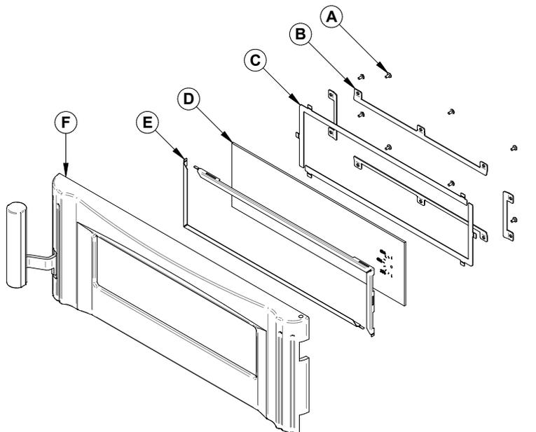
1. Dévisser la vis-sans-tête du gond en haut de la porte pour libérer le rivet (tige insérée dans le gond). Retirer le rivet en retenant la porte. Soulever la porte (**F**) pour la retirer de la penture du bas et la déposer sur une surface douce et plane.
