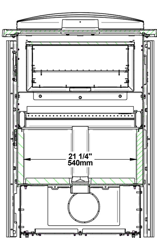
Figure 5: Vue de face - chambre à combustion
