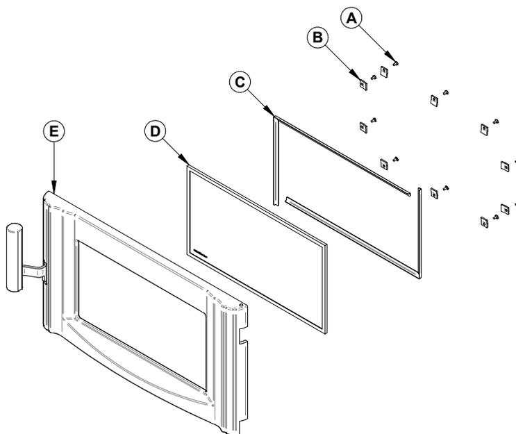
Pour remplacer la vitre (D), enlevez les huit vis (A), les huit dispositifs de retenue de vitre (B), ainsi que les cadres retiens vitre en métal (C). Enlevez la vitre endommagée et installez la nouvelle en place. Assurez-vous d'avoir un joint d'étanchéité autour de la vitre de rechange (voir procédure d'installation plus haut.) Réinstallez le cadre retiens vitre en métal ainsi que les dispositifs de retenue de vitre et fixez-le à la porte (E) avec les vis retirées plus tôt.
