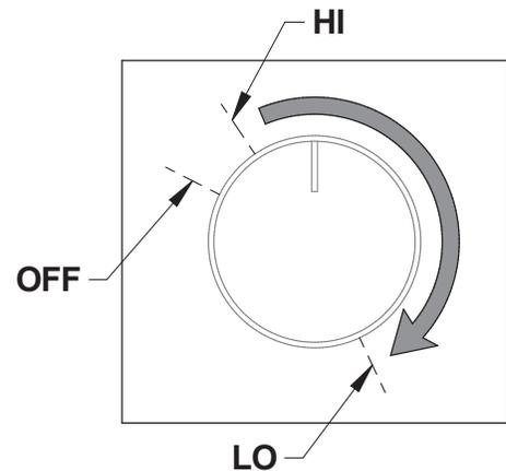
Figure 27: Rhéostat du ventilateur
