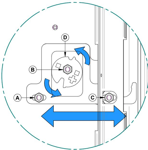
Figure 29: Ajustement porte de la chambre à combustion
