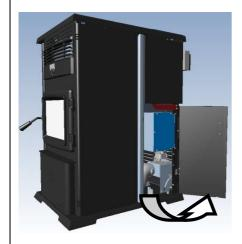
Pour accéder au capteur de pression. Ouvrir le panneau d'accès du côté droit du poêle.
