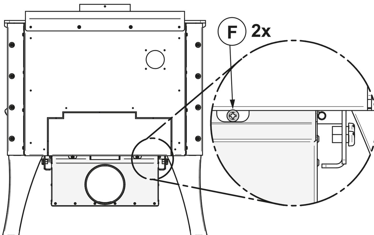
5. Fixer l'entrée d'air sur le devant du poêle avec deux vis (F, 2x).
