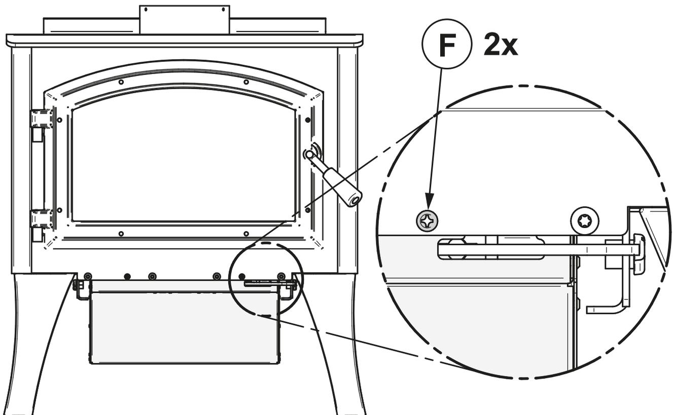
6. Réinstaller le tiroir à cendres **(C)** et le couvercle du contrôle d'air **(B)**.
