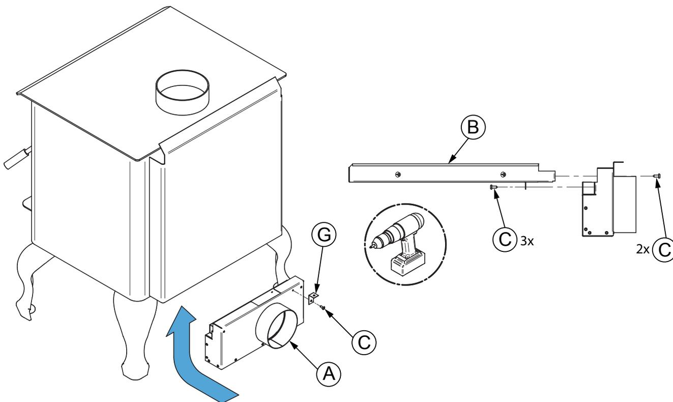
9. Terminer l'assemblage en fixant l'équerre sous la tôle de dos du poêle avec une vis **(C)**.
