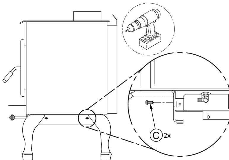
7. Fixer le plateau à l'avant de l'appareil à l'aide de 1 vis **(C)**.
